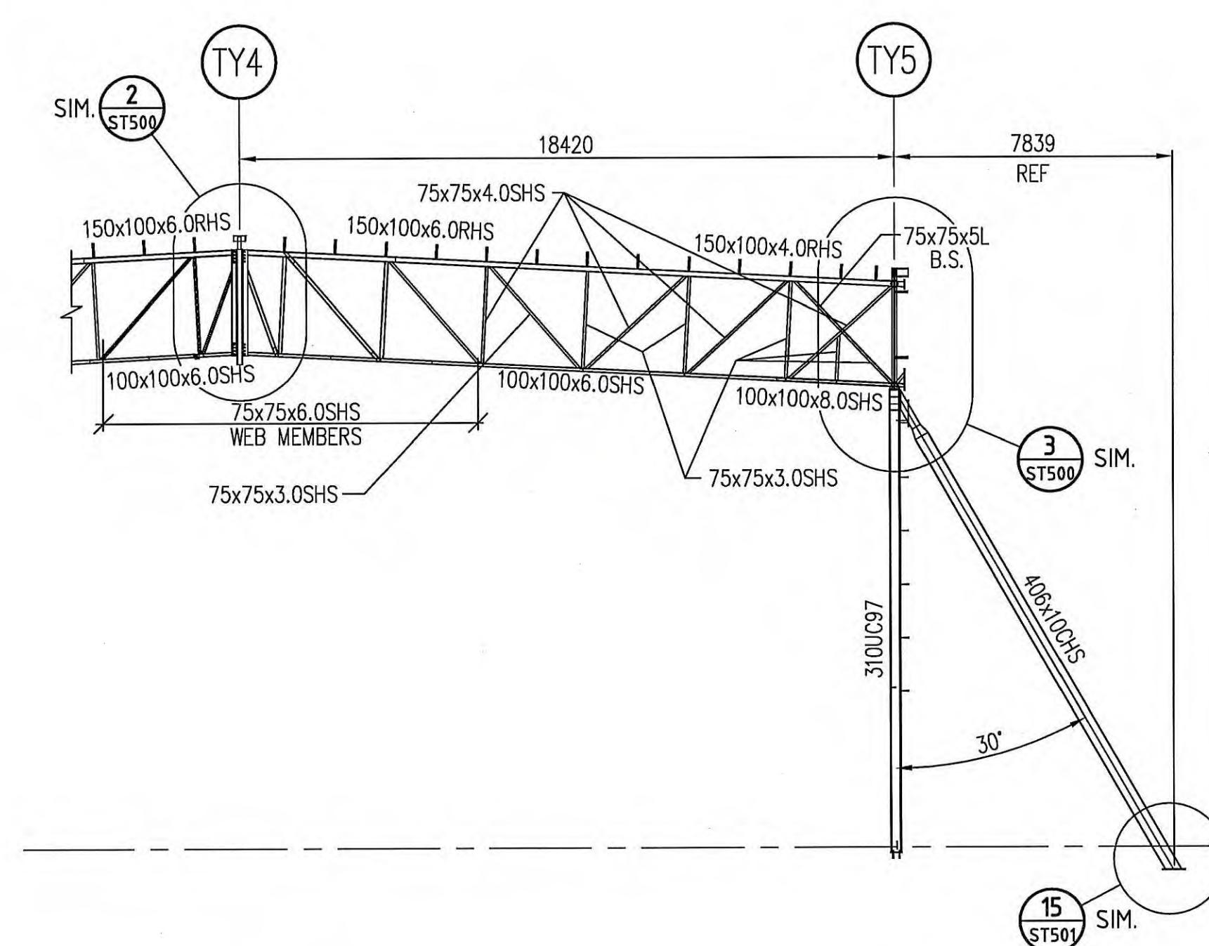
PART SECTION ON STANDARD TRUSS
