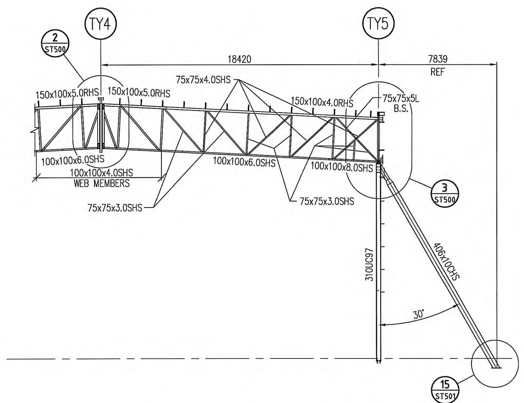
PART SECTION ON HEAVY DUTY TRUSS
